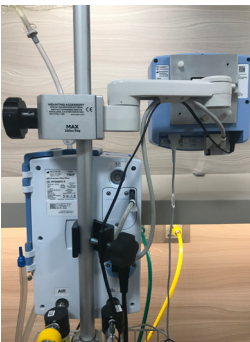
Precision Flow 및 전원에 장착되고 연결된 Oxygen Assist Module
