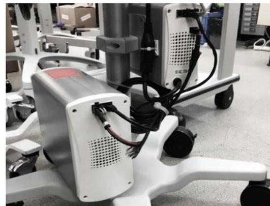
12. Monte la unidad Precision Flow con su base a una altura de 40" (pulgadas) del piso como máximo.
