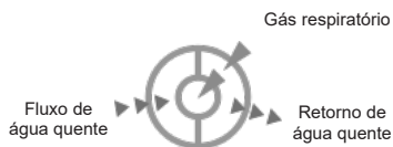
Seção transversal da tubulação
