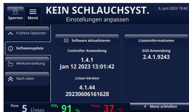
Abbildung D1: Aktivierte Schaltfläche [ Software aktualisieren ] bei Anschluss eines USB-Sticks an der Geräterückseite
