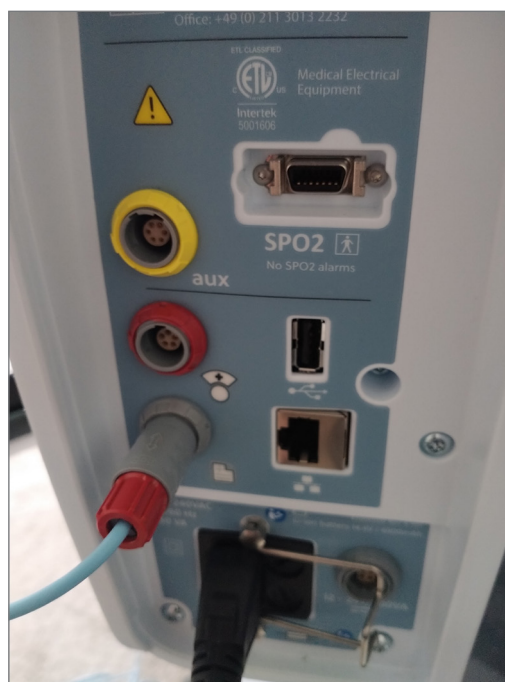
Abbildung B1: HVT 2.0 EMR-Verbindungskabel am EMR-Datenport
