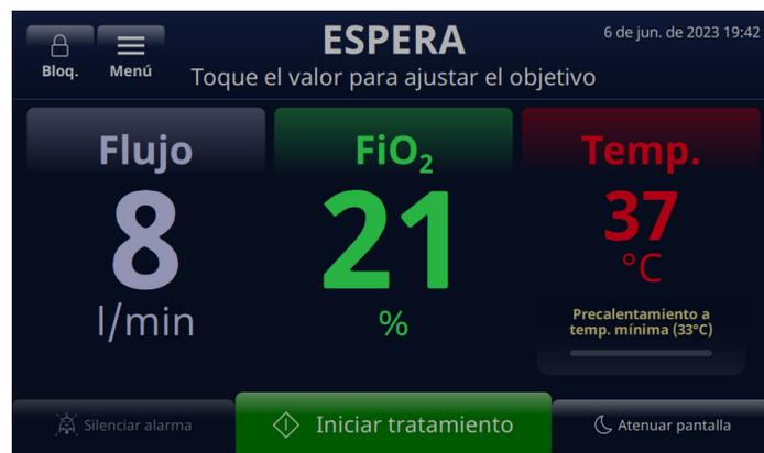
Figura 16: Barra de estado de pre calentamiento en pantalla
