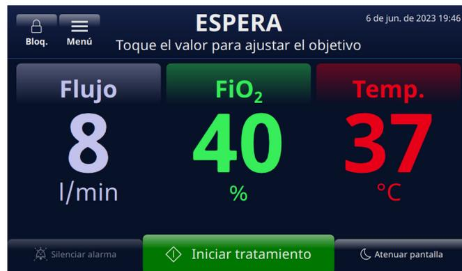
Figura 37: Desbloqueo de la pantalla para cambiar los ajustes de Flujo, FiO<sub>2</sub> o Temp.
