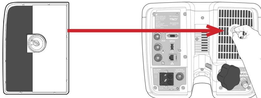
Figura 48: Introducción del filtro de entrada de aire del paciente en la parte posterior del dispositivo
