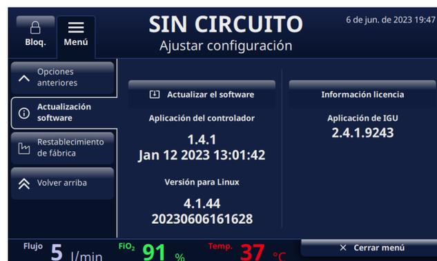
Figura D1: El botón **[Actualizar software]** se activa cuando se conecta el USB en la parte posterior del dispositivo
