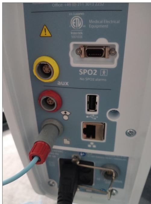
Figura B1: Cable de enlace de EMR del dispositivo HVT 2.0 colocado en el puerto de datos de EMR
