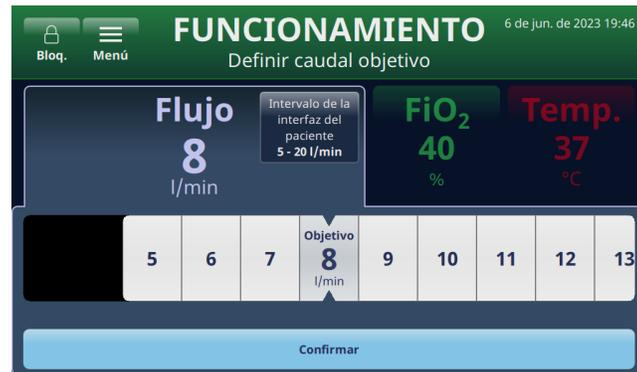
Figura 36: Ajuste del flujo mediante la barra de desplazamiento
