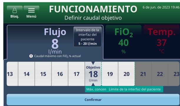
Figura 32: Notificación de los cambios en FiO<sub>2</sub> al cambiar el caudal
