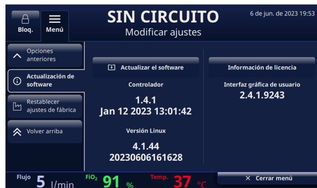
Figura D1: El botón [ Actualizar el software ] se habilita cuando el USB se conecta a la parte posterior del dispositivo.
