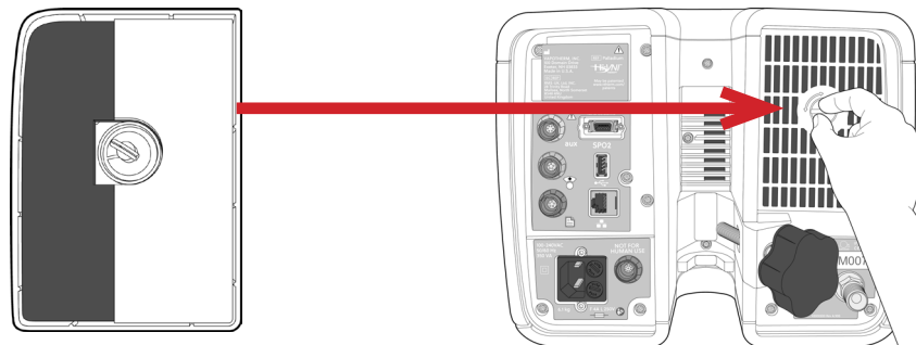
Figura 48: Inserte el filtro de entrada de aire del paciente en la parte posterior del dispositivo
