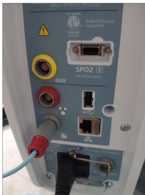
Figura B1: cable de enlace HVT 2.0 EMR colocado en el puerto de datos EMR
