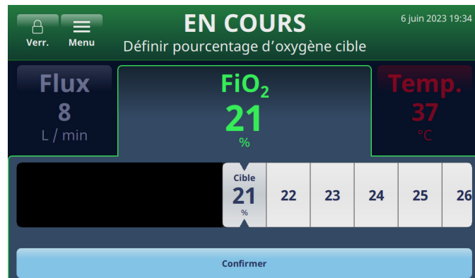
Figure 29 : Réglage du paramètre FiO 2 en utilisant la barre de défilement
