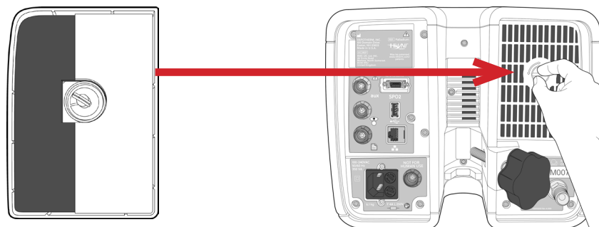
Figure 48 : Insérez le filtre d'admission d'air du patient à l'arrière de l'appareil
