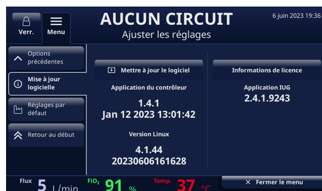
Figure D1 : Le bouton [ Mettre à jour le logiciel ] est activé quand l'USB est branché à l'arrière de l'appareil
