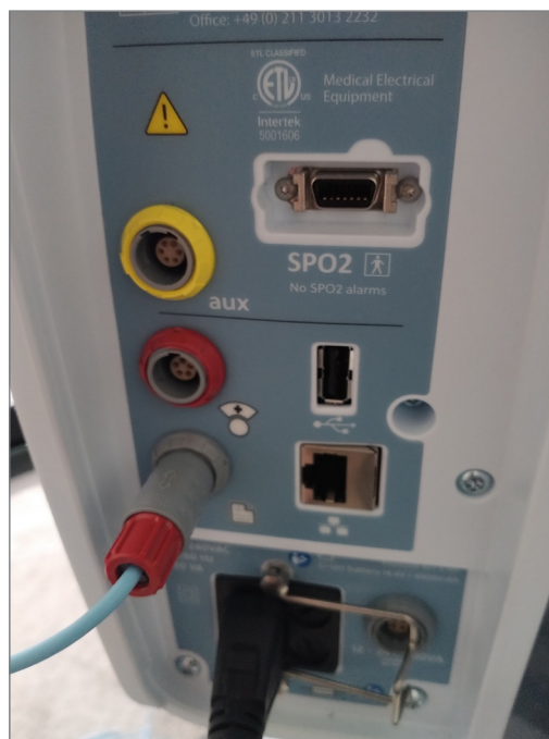
Figure B1 : Câble de liaison du système EMR du HVT 2.0 introduit dans le port de données EMR
