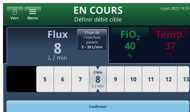
Figure 36 : Réglage du flux à l'aide de la barre de défilement
