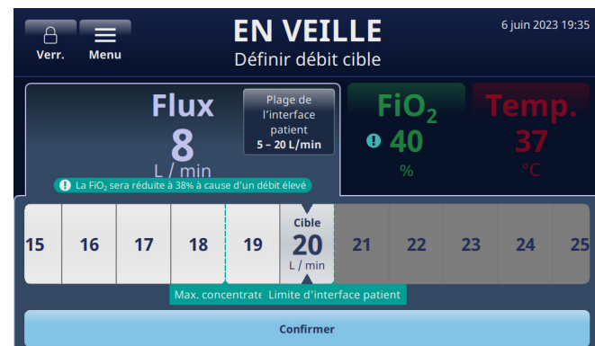
Figure 39 : Le système réinitialise le pourcentage d'oxygène en fonction du flux fort
