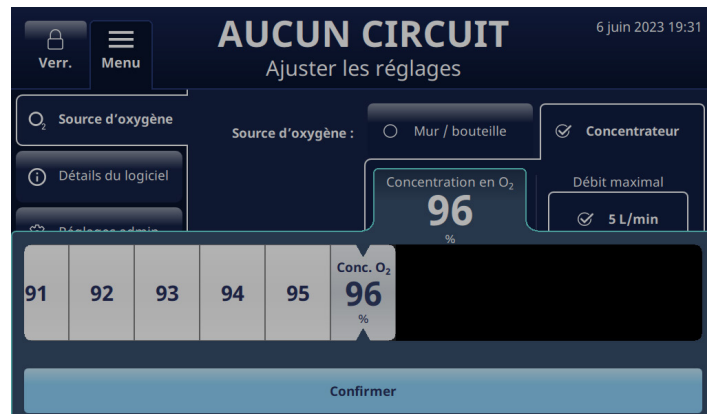
Figure 15 : Concentrateur – Barre de défilement pour modifier les réglages d'O 2
