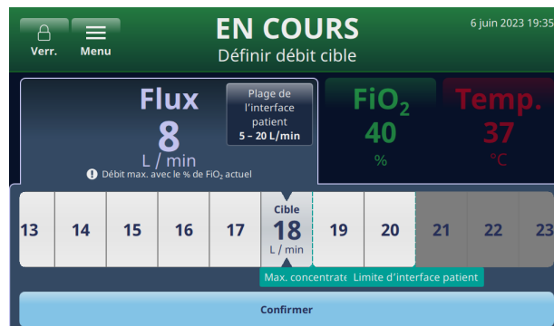
Figure 32 : Notification des modifications de la FiO 2 lors des modifications du flux
