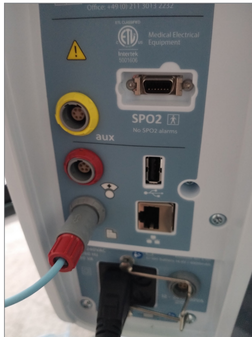
Figura B1: HVT 2.0 EMR Cavo di collegamento posizionato nella porta dati EMR
