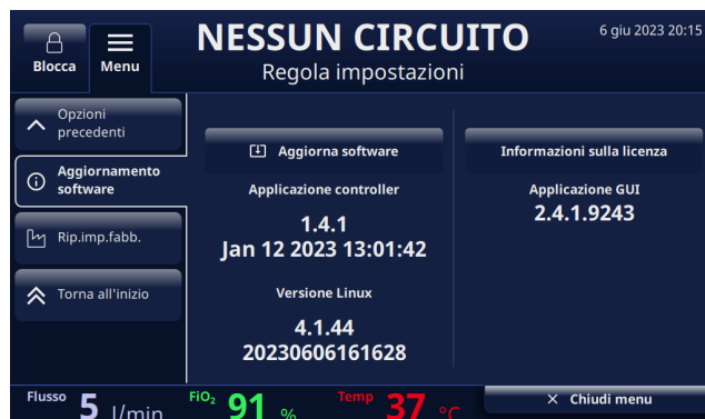
Figura D1: Pulsante [Aggiorna software] abilitato quando la chiavetta USB è inserita sul retro del dispositivo
