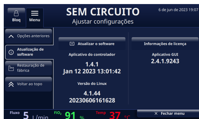
Figura D1: O botão [Atualizar o software] é ativado quando o USB é conectado à parte traseira do dispositivo
