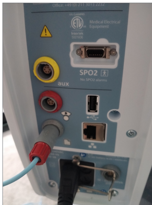
Figura B1: Cabo de link EMR HVT 2.0 colocado na porta de dados de EMR
