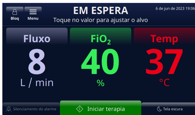
Figura 37: Desbloqueie a tela para alterar as configurações de Fluxo, FiO 2 ou Temp
