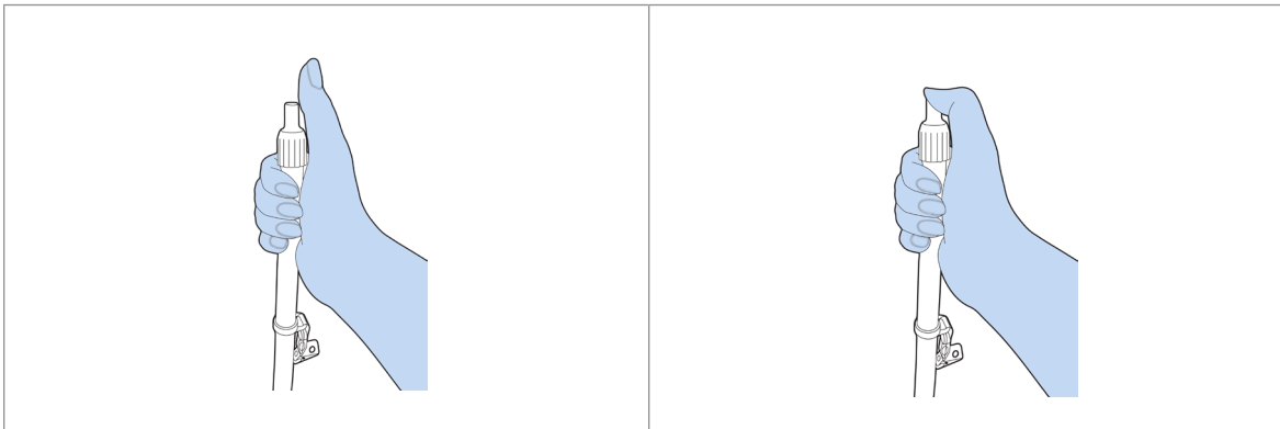
Figura 43: Verificando a funcionalidade do sistema de alarme
