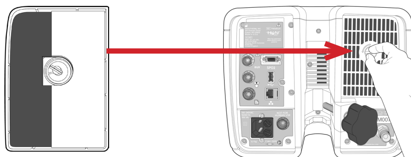
Figur 48: Sätt i patientens luftintagsfilter på baksidan av enheten
