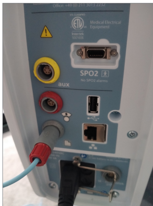
Figur B1: HVT 2.0 EMR-länkkabel placerad i EMR-dataport
