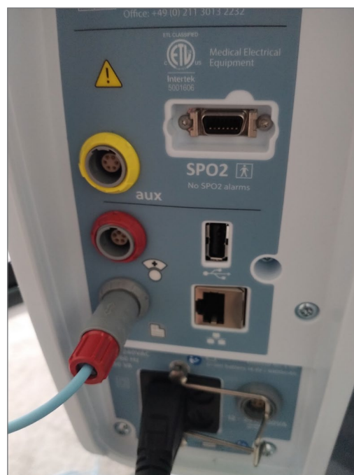
Abbildung B1: HVT 2.0 EMR-Verbindungskabel am EMR-Datenport
