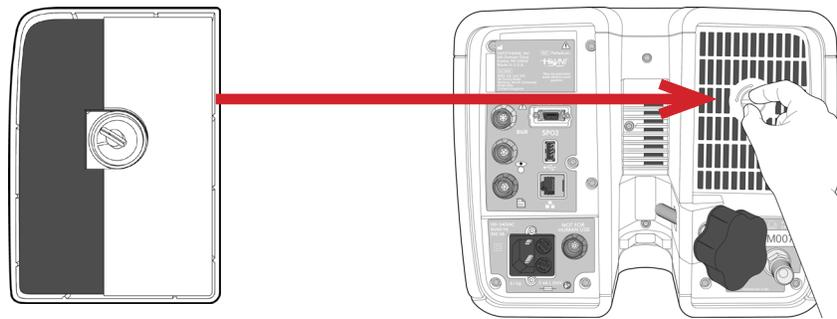
Gambar 53: Masukkan filter masuk udara pasien di bagian belakang perangkat
