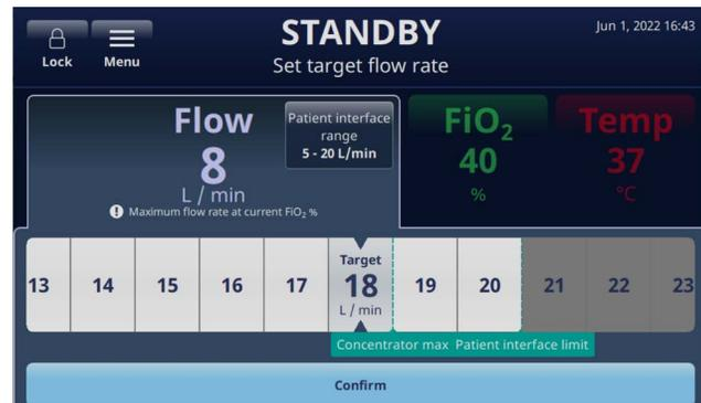
Gambar 43: Mengatur parameter laju aliran target
