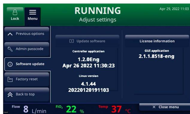
Gambar D1: Tombol [**Perbarui perangkat lunak**] diaktifkan saat USB dicolokkan ke bagian belakang perangkat
