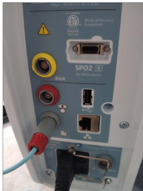
Gambar B1: Kabel Tautan HVT 2.0 EMR yang ditempatkan di lubang sambungan data EMR
