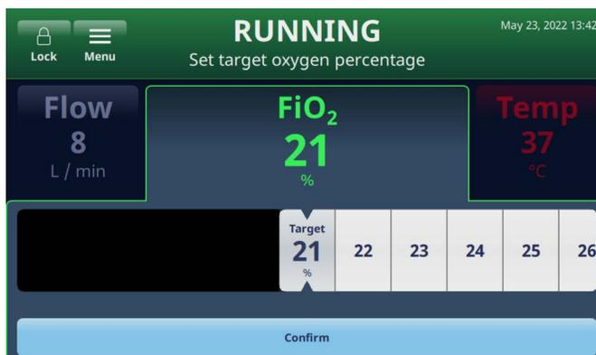
Figura 29: Definição do parâmetro FiO<sub>2</sub> com a barra de deslocamento
