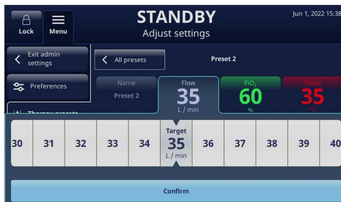
Figura 20: Ajustar definições – Predefinição de fluxo alvo da terapia
