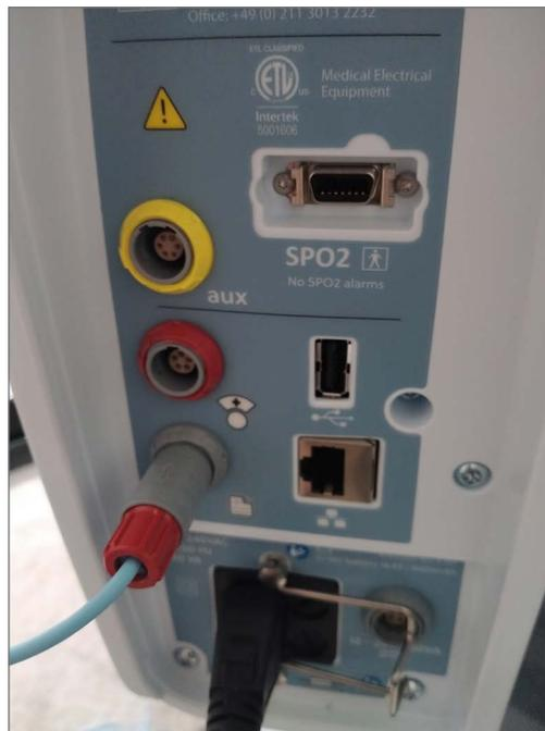
Figura B1: Cabo de ligação de EMR do HVT 2.0 colocado na porta de dados EMR
