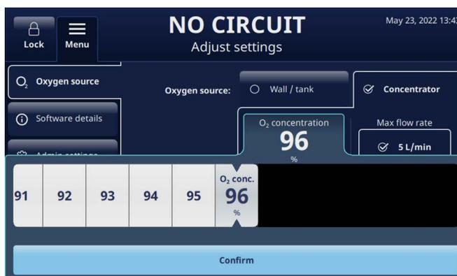
Figura 15: **Concentrador** – Barra de deslocamento para alterar a concentração de O<sub>2</sub>
