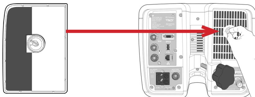
Figura 53: Inserir o filtro de admissão de ar do doente na parte de trás do dispositivo
